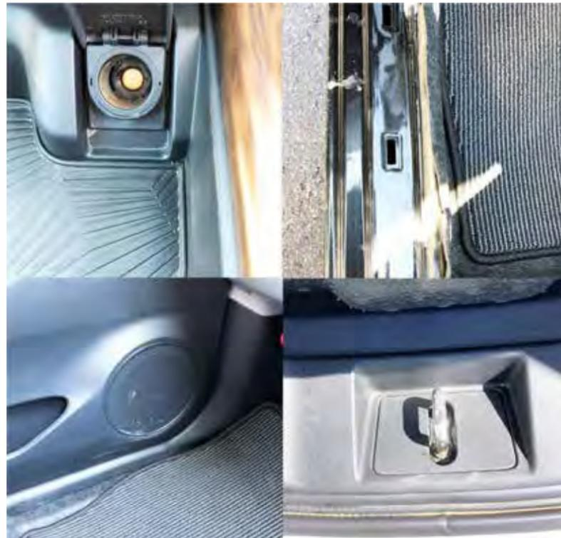
左から右回り>シガーソケットの中に錆が。フロアマットをめくると土が残る。トランクのヒンジにも錆。ドアスピーカーの下部に冠水した跡
